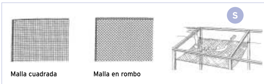
Tipo S. Red de Seguridad con cuerda perimetral
